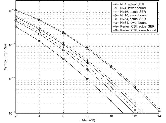
Fig. 4. The actual SER versus the lower bound ( $N_t = 4$ , QPSK)
