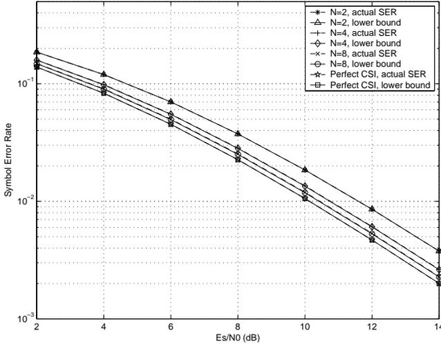
Fig. 2. The actual SER versus the lower bound ( $N_t = 2$ , QPSK)
