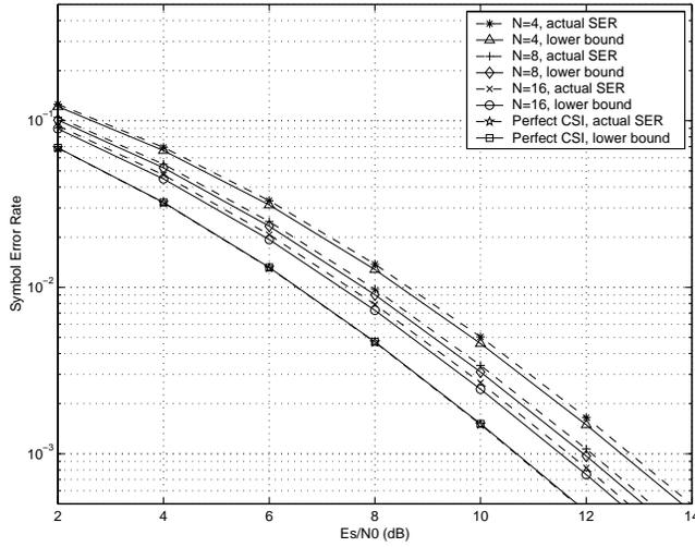
Fig. 3. The actual SER versus the lower bound ( $N_t = 3$ , QPSK)
