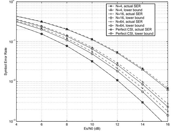
Fig. 5. The actual SER versus the lower bound ( $N_t = 4$ , 16-QAM)
